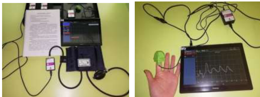
Рис. 3. Регистрация данных датчиками артериального давления и частоты сердечных сокращений
