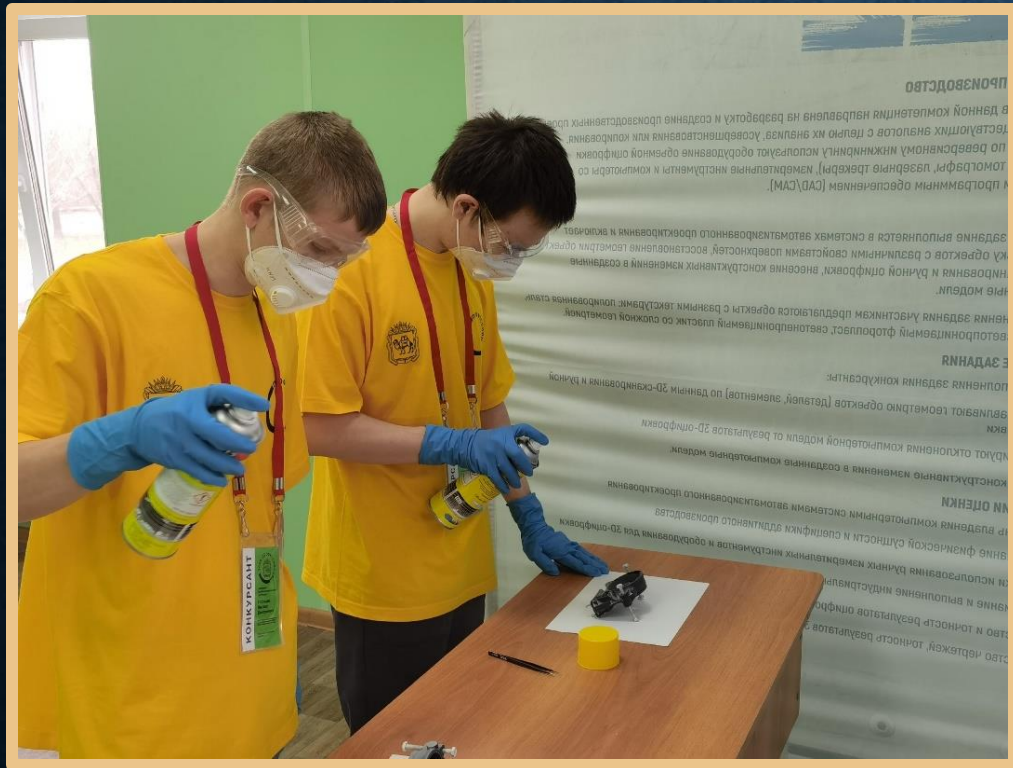
Нанесение дефектоскопического спрея на деталь
