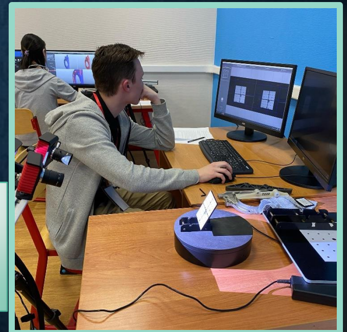
Калибровка 3D сканера с помощью калибровочного поля и поворотного стола
