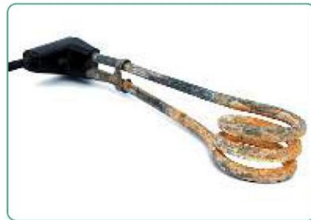
Рис. 80. Накипь на нагревательном элементе кипятильника
